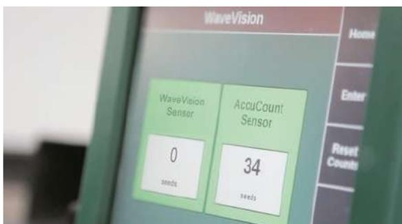
O sensor WaveVision® não se deixa enganar pela poeira como o sensor óptico. Veja a diferença entre esses dois sensores sendo informada pelo monitor 20|20 SeedSense®.
